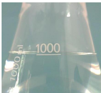
Photo 2 : Compléter un becher avec précisément 1 litre d'ECOWASH pour la mesure de la densité
